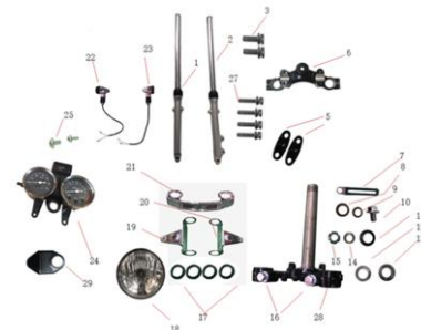
FIG. 12 T DE BARRAS, BARRAS Y TABLERO
