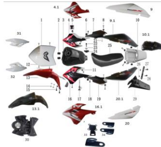
FIG. 8 COBERTORES, TANQUE DE GASOLINA Y SILLON
