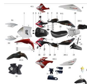
FIG. 9 COBERTORES, TANQUE DE GASOLINA Y SILLON
