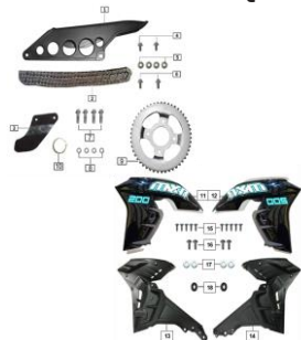
FIG.25 CADENA, CUBRECADENA Y COBERTOR DE TANQUE
