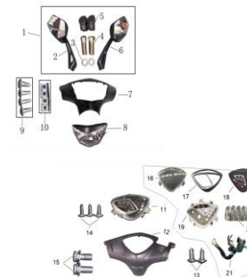
FIG. 15 SILVIN, RETROVISORES Y TABLERO
