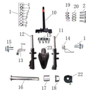
FIG. 21 LODERA DELANTERA, BARRAS Y T DE BARRAS
