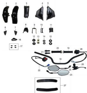
FIG.13 LODERAS, COBERTORES, TIMON Y SWITCH
