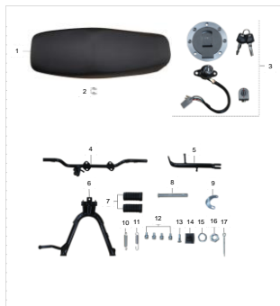
FIG.19 SILLON, SWITCH Y PATAS
