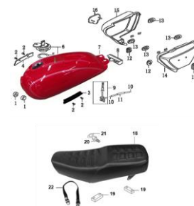
FIG. 15 TANQUE DE GASOLINA, COBERTORES Y SILLON
