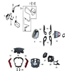
FIG. 12 SISTEMA ELECTRICO, SILVIN, PIDEVIAS Y TABLERO
