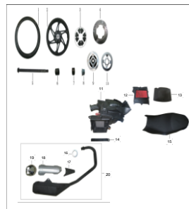
FIG. 17 LLANTA TRASERA, FILTRO DE AIRE, SILLON Y ESCAPE
