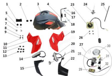
FIG.13 TANQUE DE GASOLINA Y COBERTORES
