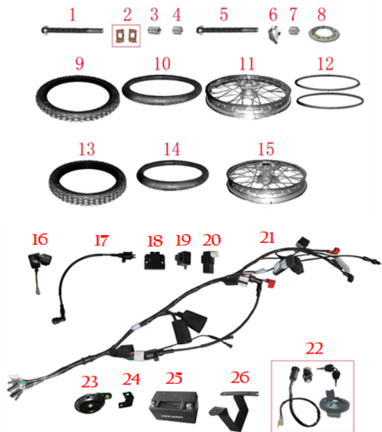
FIG. 11 LLANTAS Y SISTEMA ELECTRICO
