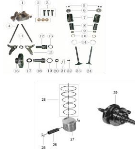
FIG. 2 EJE DE LEVAS, VALVULAS, CIGÜÑAL Y PISTON
