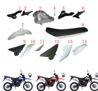
FIG. 8 COBERTORES, TANQUE DE GASOLINA Y SILLON
