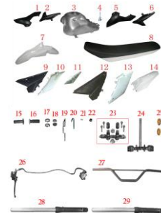
FIG. 9 COBERTORES, TANQUE DE GASOLINA, SILLON Y TREN DELANTERO
