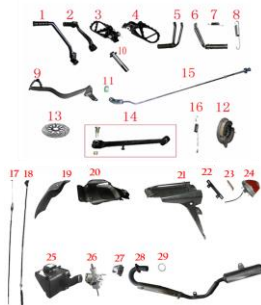
FIG. 10 ESCAPE, FILTRO DE AIRE, POSAPIES Y PATAS
