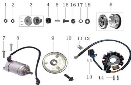
FIG. 4 CLUTCH, PLANTA Y MOTOR DE ESTARTER
